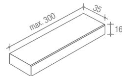
Die Austrittstufe ist bei Verwendung einer Fahrstufe zwingend erforderlich.
